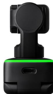
Link se connecte à un ordinateur via un câble USB et peut être monté avec le clip intégré ou le point de montage  $\frac{1}{4}$ ". Le contrôle de Link est facile via son logiciel de bureau ou ses gestes.
